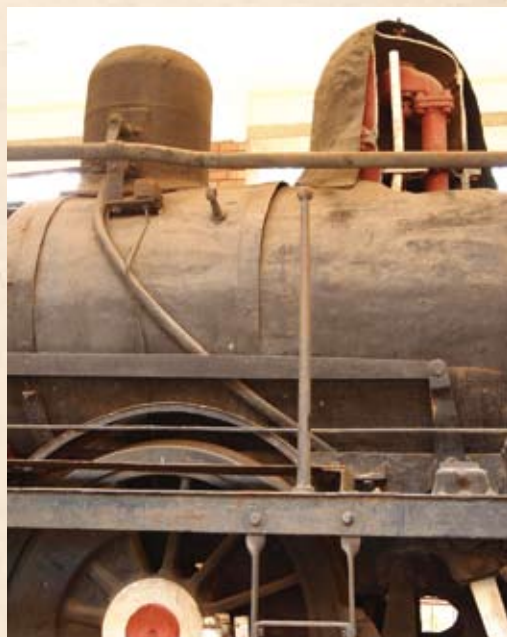
左側駝峰有管線將內部的沙子引導到車輪前，以增加爬坡力。
